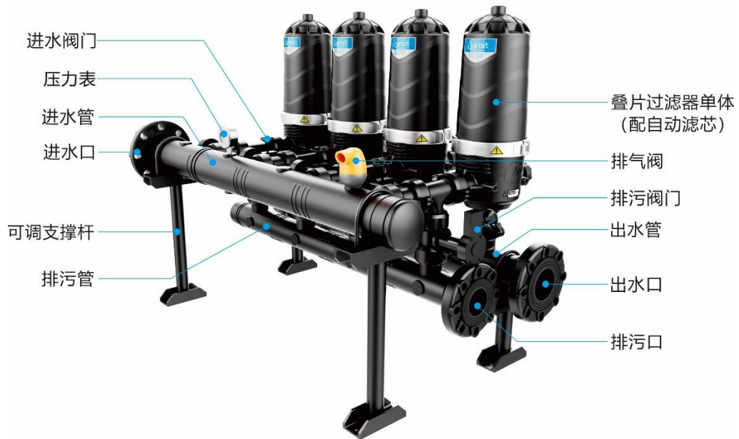
手动反冲洗叠片过滤器安装示意图
