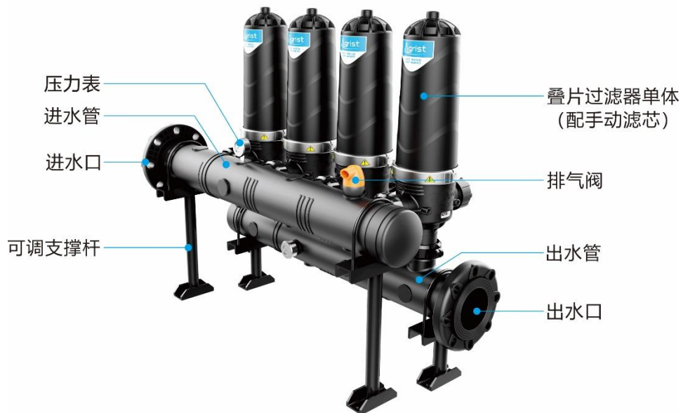
手动清洗叠片过滤器安装示意图
